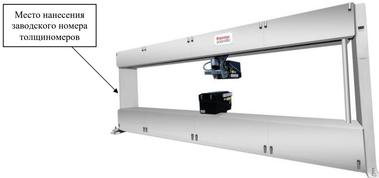
Рисунок 1 – Общий вид толщиномеров с указанием места нанесения заводского номера
