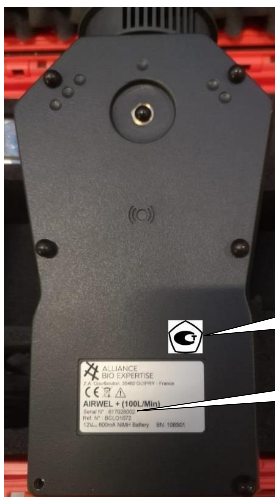
Рисунок 2 – Общий вид маркировочной таблички пробоотборников и место нанесения знака утверждения типа
