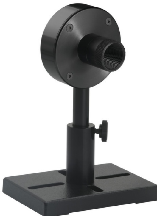
Рисунок 1 – Общий вид преобразователя измерительного термоэлектрического средней мощности и энергии импульсов лазерного излучения 3A-QUAD .
