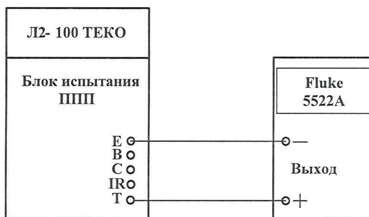
Рисунок 4. Схема измерения тока коллектора.
