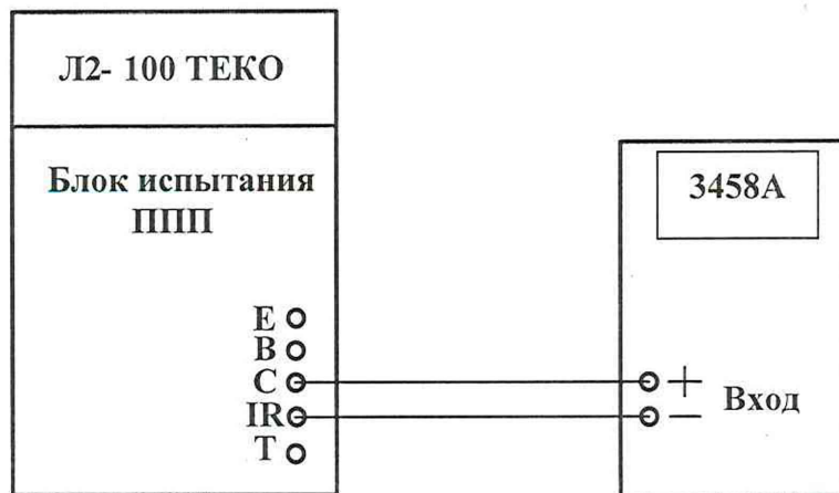
Рисунок 5. Схема измерения начального и обратного тока
