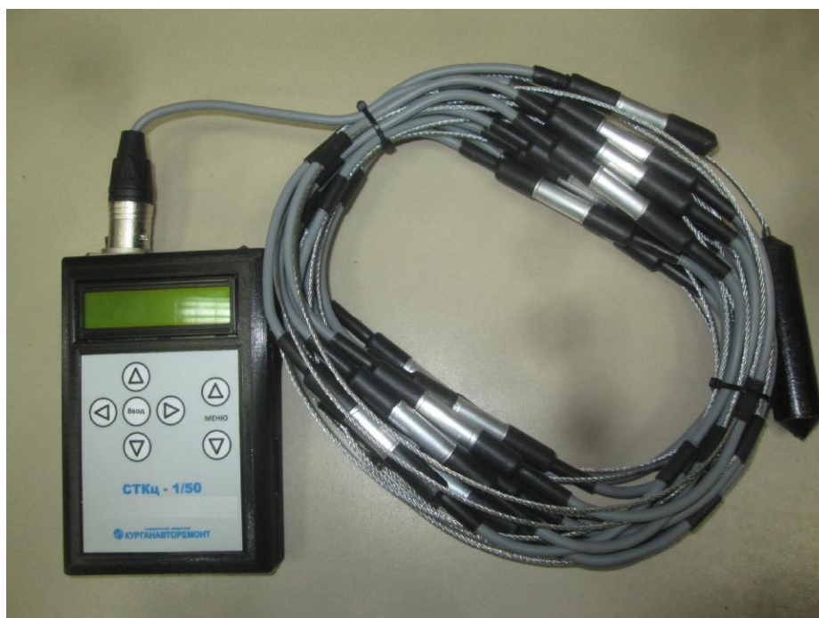
Рисунок 1 – Общий вид комплексов для измерений температуры грунтов СТКц-1/50
