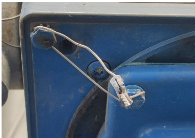
Рисунок 5 – Схема пломбировки механического отсчетного устройства счетчика
