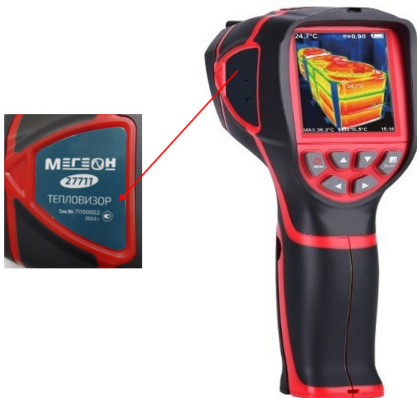
Рисунок 1 – Общий вид тепловизоров и места нанесения заводских номеров и знака утверждения типа
