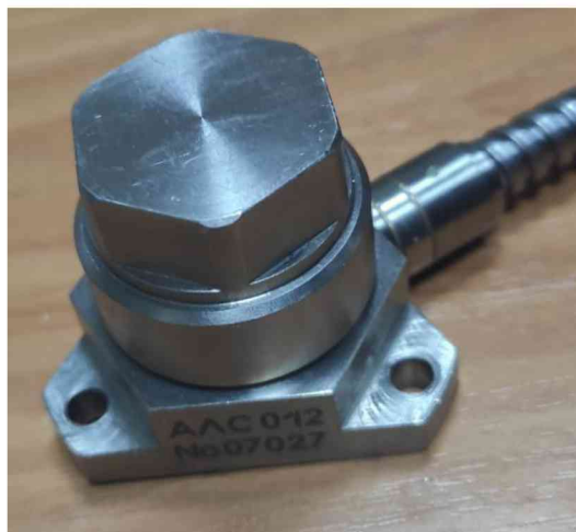
Рисунок 1 – Общий вид первичных преобразователей АЛС 012.
