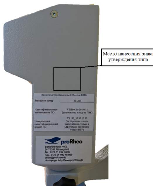
Рисунок 3 – Место нанесения знака утверждения типа на корпусе вискозиметра
