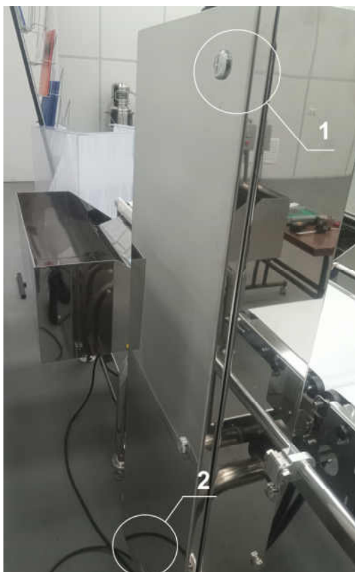
Рисунок 2 – Место пломбирования (1), место нанесения маркировочной таблички (2) со знаком поверки, знаком утверждения типа, заводским номером
