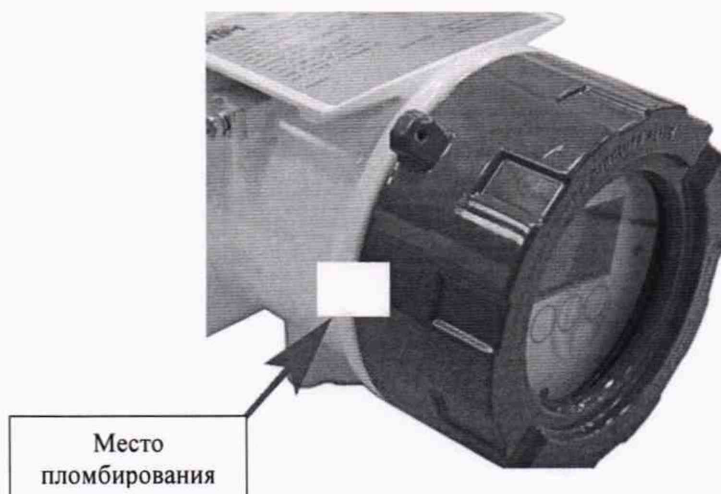
Рисунок Б.1 – Схема пломбировки от несанкционированного доступа и место нанесения знака поверки УЗС-1М
