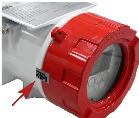
Рисунок 2 – Схема опломбирования УЗС-1М
