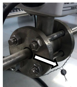
Рисунок 2 – Схема пломбировки от несанкционированного доступа, обозначение мест нанесения знака поверки
