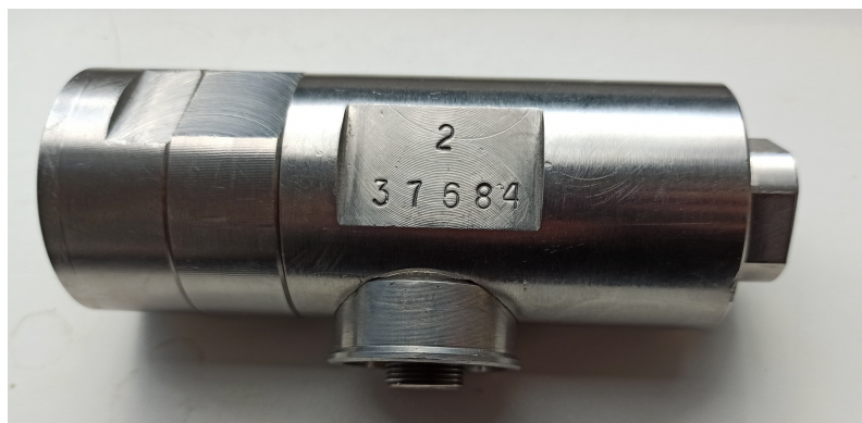
Рисунок 1 – Общий вид преобразователя переменного давления пьезоэлектрического ППД-2.
