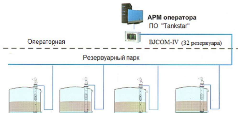
Рисунок 4 – Архитектура системы в резервуарном парке
