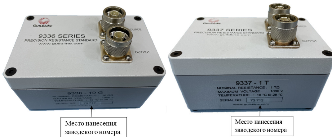
Рисунок 1 - Общий вид мер 933 с указанием мест нанесения заводского номера Модификация 9336 – слева, модификация 9337 – справа
