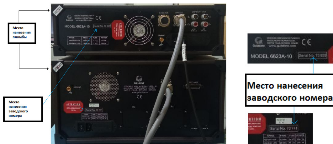
Рисунок 2 - Общий вид задней панели моста-компаратора 6622А (нижний прибор) с расширителем 6623А (верхний прибор) с указанием места пломбировки и заводского номера
