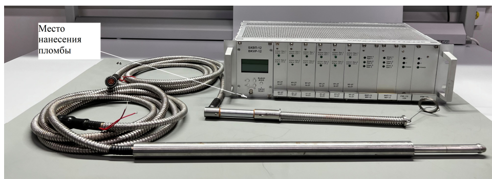
Рисунок 1–Общий вид измерителей линейных перемещений многоканальных
