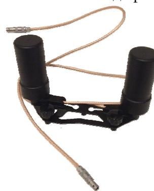
Рисунок 4 – Общий вид ГНСС-приёмника
