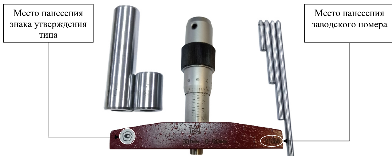
Рисунок 1 – Общий вид глубиномеров с указанием мест нанесения заводского номера и знака утверждения типа
