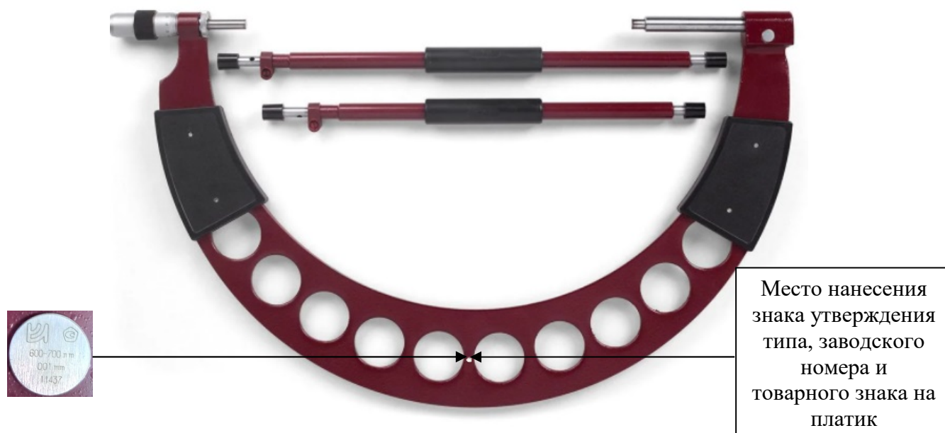
Рисунок 1 – Общий вид микрометров гладких МК модификаций: МК 700, МК 750, МК 800, МК 850, МК 900, МК 1000, МК 1050
