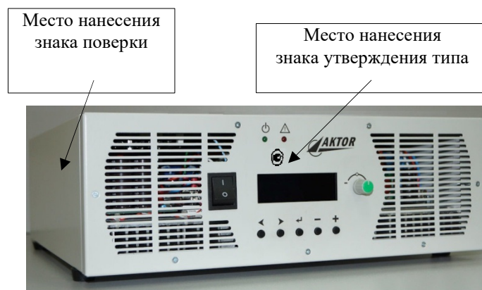
Рисунок 1 – Общий вид с указанием места нанесения знака поверки и знака утверждения типа преобразователей ПНБА11-2/40/1200-КР, ПНБА31-3/40/1200-КР, ПНБА13-2/40/1200-КР, ПНБА33-3/40/1200-КР, ПНБА11-2/160/1200-КР, ПНБА13-2/160/1200-КР, ПНБА33-4/160/1200-КР, ПНБА11-2/300/1200-КР, ПНБА31-4/300/1200-КР, ПНБА13-2/300/1200-КР, ПНБА33-4/300/1200-КР
