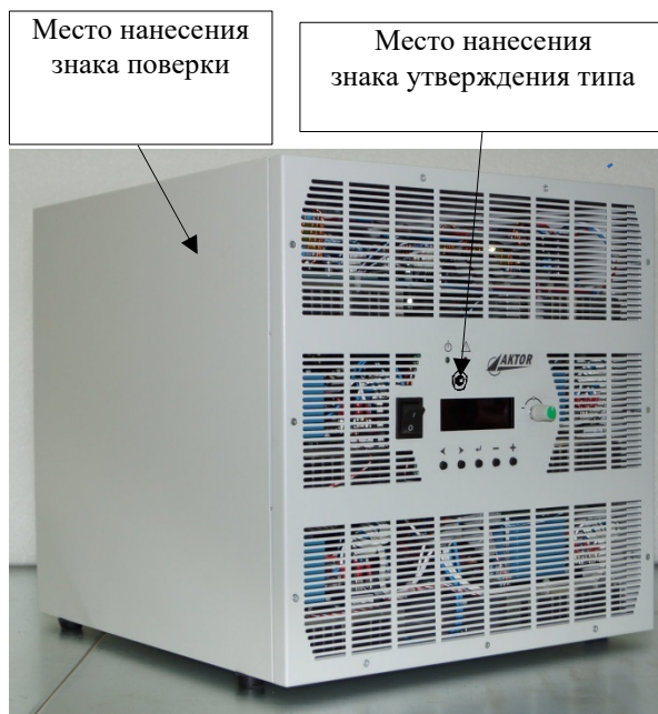
Рисунок 3 – Общий вид с указанием места нанесения знака поверки и знака утверждения типа преобразователей ПНБА33-16/160/1200-КР, ПНБА33-16/300/1200-КР
