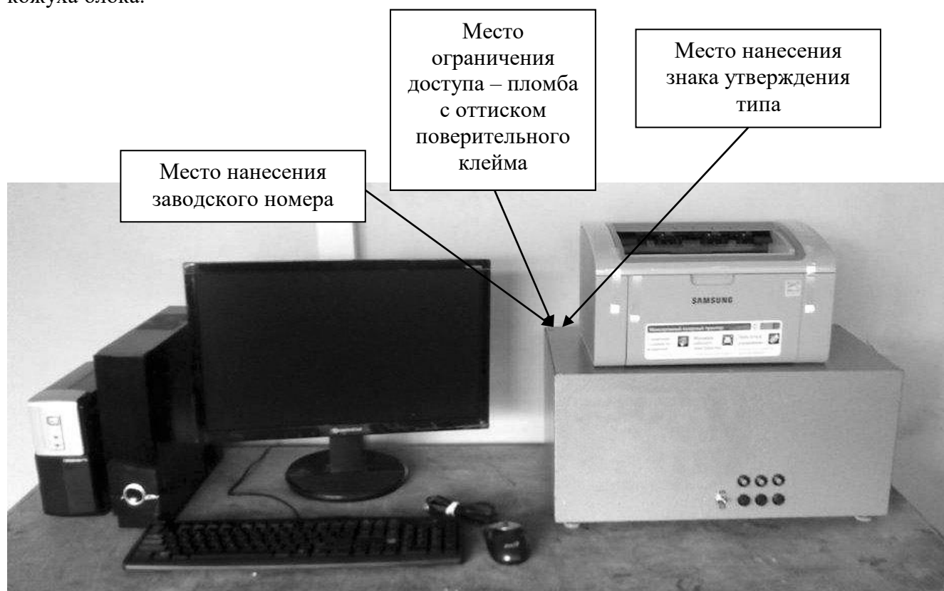
Рисунок 1 – Общий вид БЭПТ устройств УЗОТ-П с указанием места ограничения доступа к местам настройки (регулировки), места нанесения знака утверждения типа, места нанесения заводского номера
