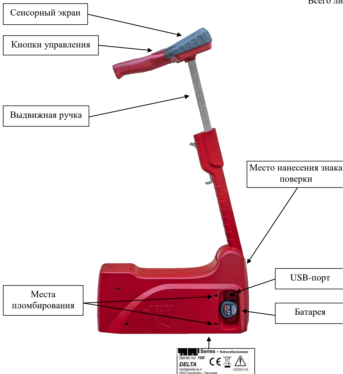
Рисунок 1 - Общий вид ретрорефлектометров LTL3500 со схемой пломбирования и обозначением мест нанесения знака поверки и заводского номера
