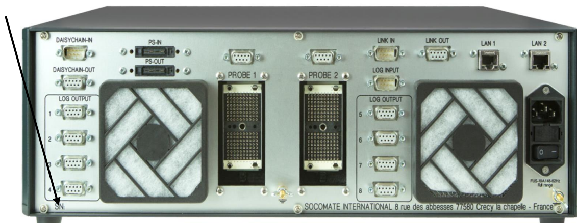
Рисунок 2 - Общий вид задней панели ультразвукового прибора (электронного блока) системы дефектоскопической ультразвуковой FAAST-PA
