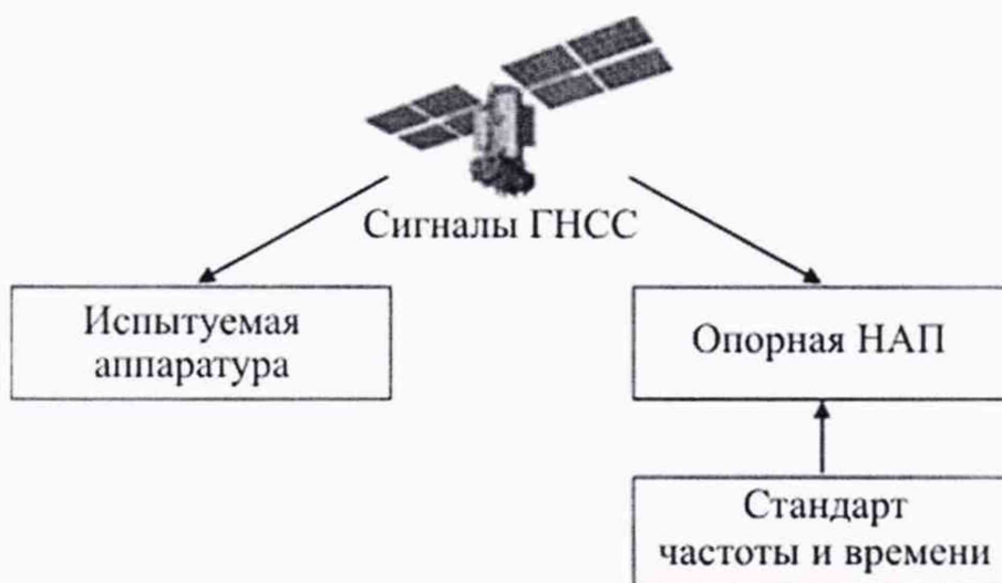
Рисунок 1 — Структурная схема проведения измерений
