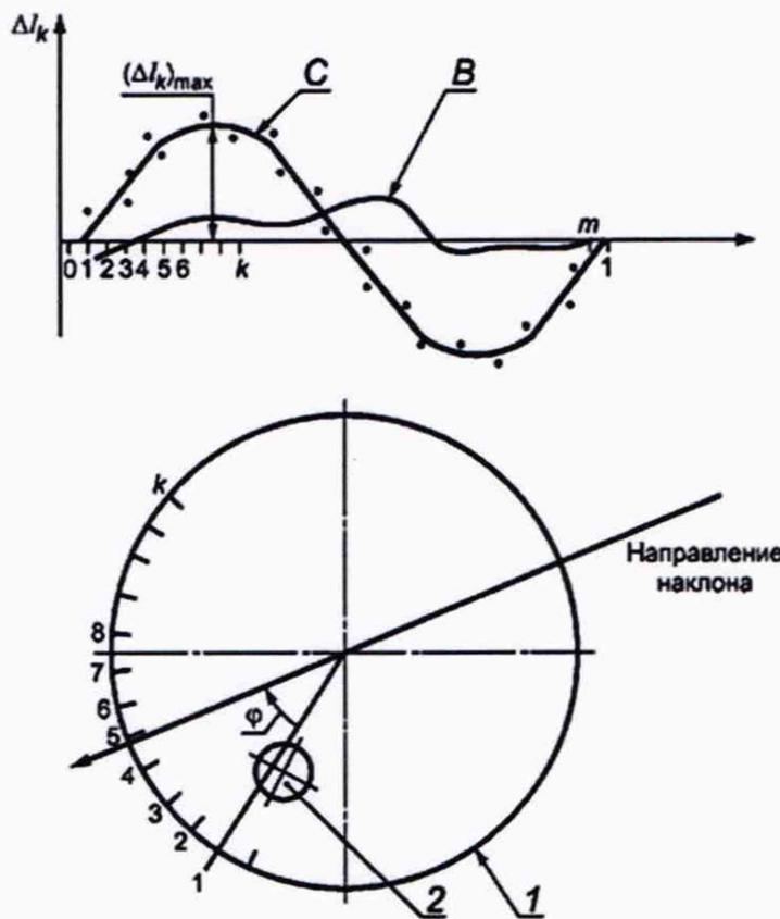
1 - контур дна резервуара; 2 - измерительный люк;  $\Delta l_k$  - функция, вычисляемая по формулам (4) и (5); С, В - графики функции  $\Delta l_k$  при наличии и отсутствии наклона резервуара соответственно;  $(\Delta l_k)_{\max}$  - максимум функции  $\Delta l_k$ ;  $m$  - число разбивок;  $k$  - номер разбивки;  $\varphi$  - угол направления наклона резервуара
