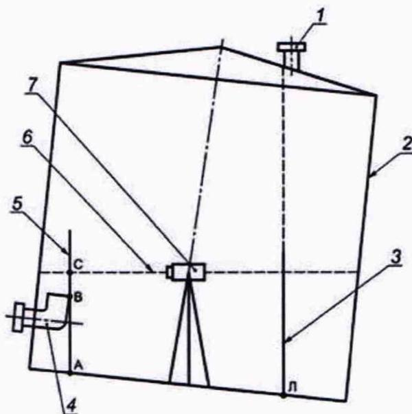
1 - измерительный люк; 2 - резервуар; 3 - рейка, установленная в точке Л;
