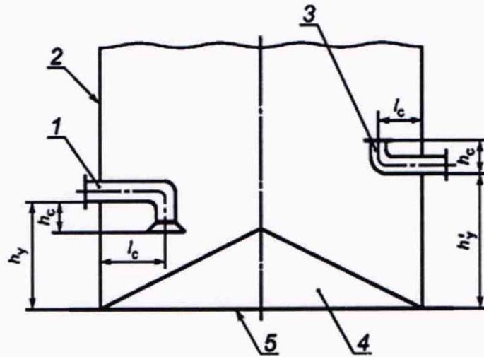
1, 3 - приемно-раздаточные устройства; 2 - стенка резервуара; 4 - неровности дна; 5 - контур дна;  $h_y$ ,  $h'_y$  - высоты приемно-раздаточных устройств;  $h_c$  - расстояние от нижней образующей приемно-раздаточного устройства до его нижнего или верхнего среза;
