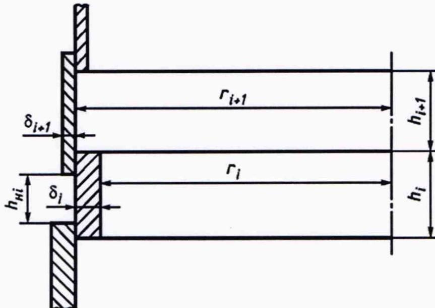
$r_i$ ,  $h_{ni}$  и  $h_i$ ,  $\delta_i$  - внутренний радиус, внешняя и внутренняя высота, толщина стенки  $i$ -го пояса соответственно;  $r_{i+1}$ ,  $h_{i+1}$ ,  $\delta_{i+1}$  - внутренний радиус, внутренняя высота, толщина  $i + 1$ -го пояса соответственно
