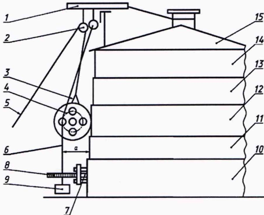
1 - штанга; 2 - блок; 3 - каретка измерительная; 4 - колеса каретки; 5 - тяговый канат; 6 - нить отвеса;
