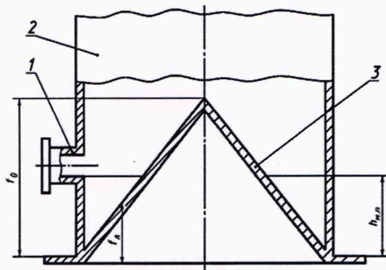
1 - приемно-раздаточный патрубок; 2 - стенка резервуара; 3 - неровности дна;
