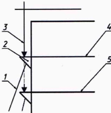
1 - штанга упорного угольника 90°; 2 - упорный угольник 90°; 3 - измерительная рулетка с грузом;
