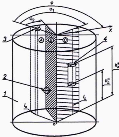
1 - стенка резервуара; 2 - приемно-раздаточный патрубок; 3 - измерительный люк; 4 - внутренняя деталь;
