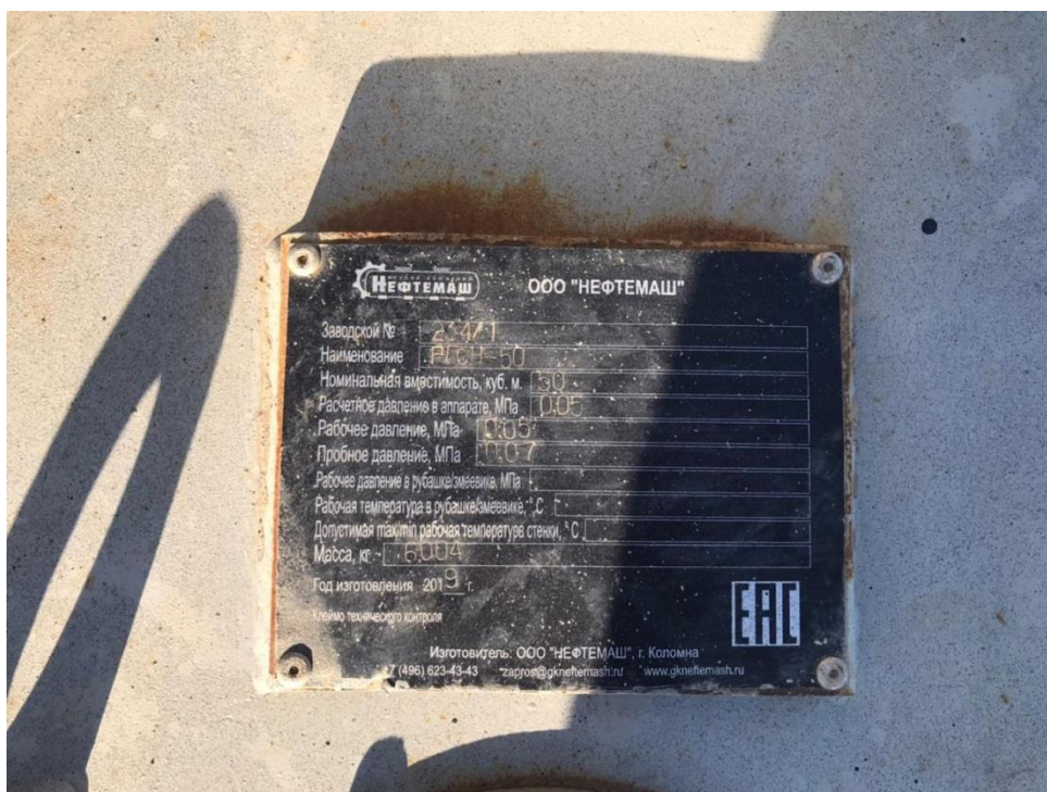
Рисунок 7 – Заводской номер резервуара РГСН-50, зав. №234/1.
