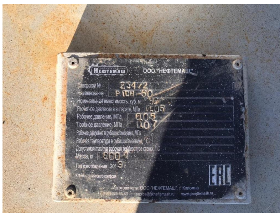
Рисунок 9 – Заводской номер резервуара РГСН-50, зав. №234/2.
