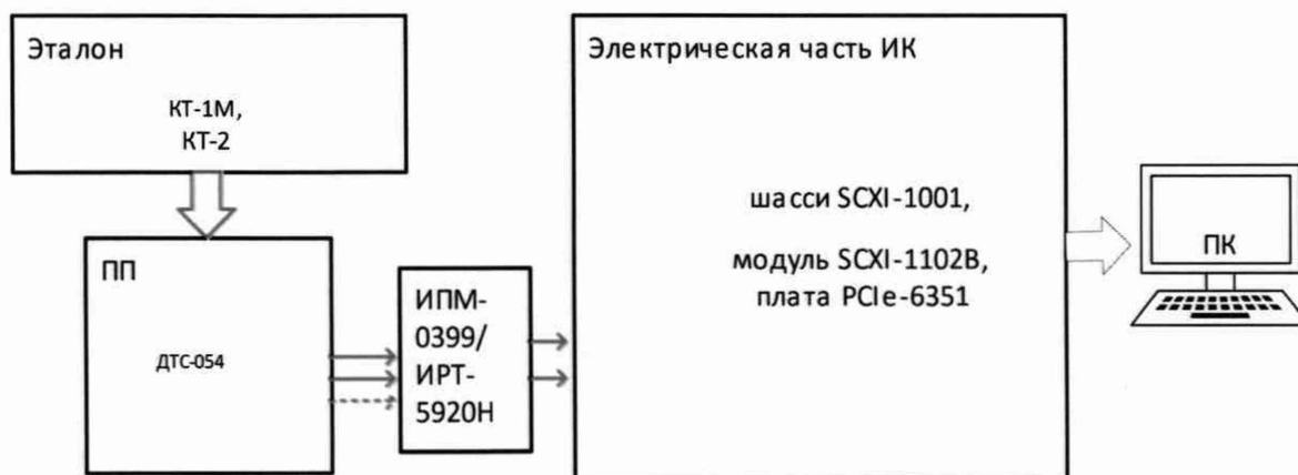
Рисунок 4 – Схема поверки ИК температур газобразных и жидких сред комплектным способом
