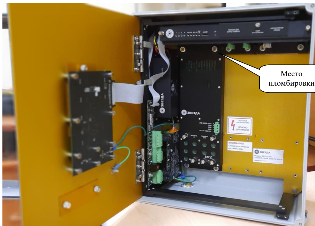
Рисунок 5 - Внутренняя компоновка систем Звезда всех модификаций с местом пломбировки от несанкционированного доступа.
