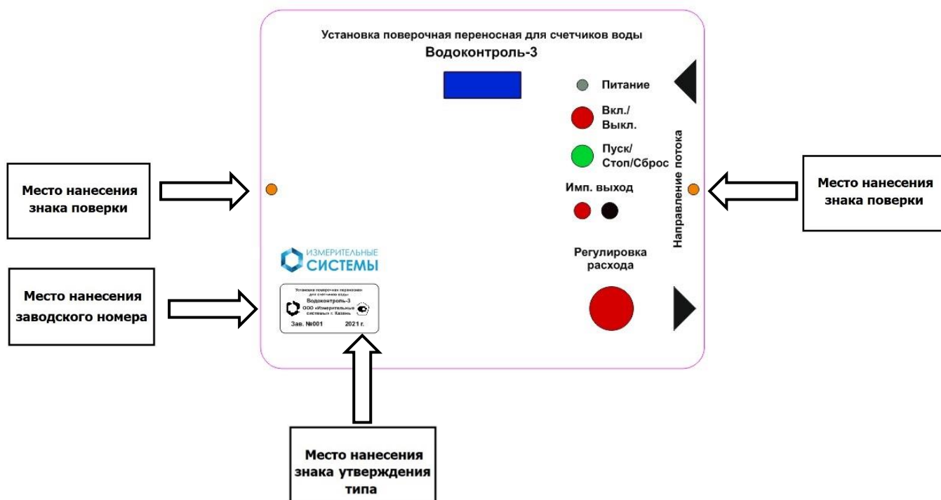
Рисунок 2 – Общий вид средства измерений с указанием мест нанесения знака утверждения типа, знака поверки, заводского номера
