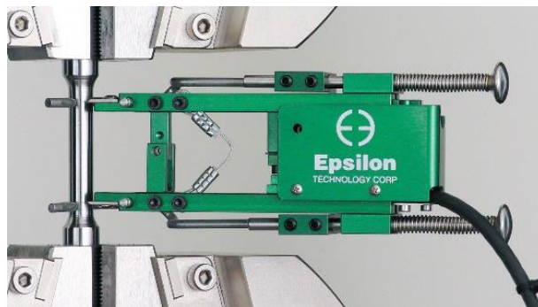
Рисунок 10 – Общий вид датчиков измерений линейных размеров (деформации) модификаций 3542-025M-050 (-LT/-ST/-HT1/-HT2/-LHT), 3542-050M-010 (-LT/-ST/-HT1/-HT2/-LHT)
