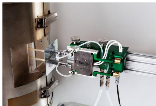
Рисунок 6 – Общий вид датчиков измерений линейных размеров (деформации) модификаций 3549-010M-050 (-ST/-HT) 3549-050M-050 (-ST/-HT)
