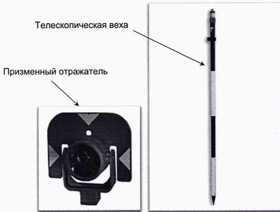
Рисунок А.1 – Веха телескопическая с призмным отражателем
