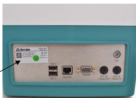
Рисунок 2 – Место размещения маркировочной таблички на задней панели титраторов Пломбирование титраторов не предусмотрено.
