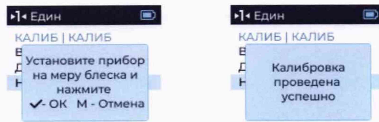
Рисунок 8 – Проведение настройки (калибровки).
