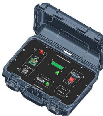
Рисунок 2 – Общий вид наземной части инклинометров телеметрической системы «БИТГЕОКУРС»
