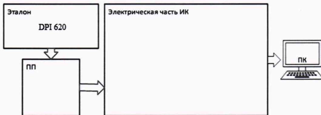
Рисунок 1 – Схема поверки ИК абсолютных, избыточных и разности давлений газообразных и жидких сред комплектным способом
