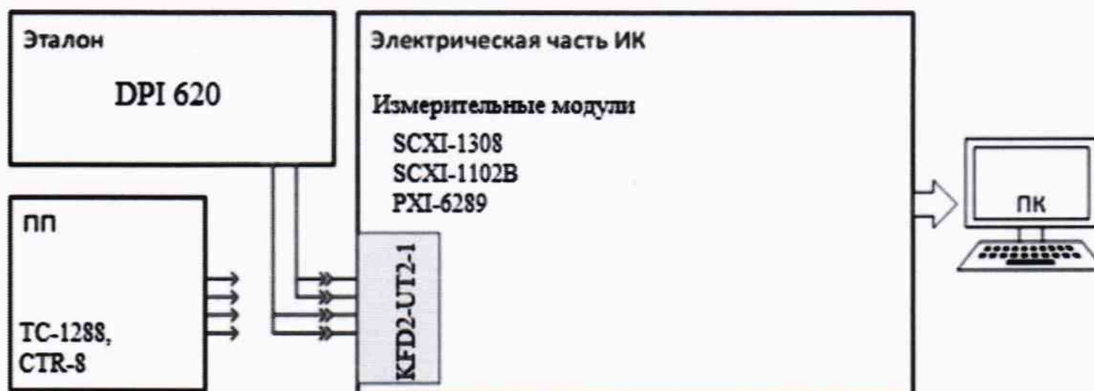
Рисунок 3 – Схема поверки ИК температур газообразных и жидких сред поэлементным способом
