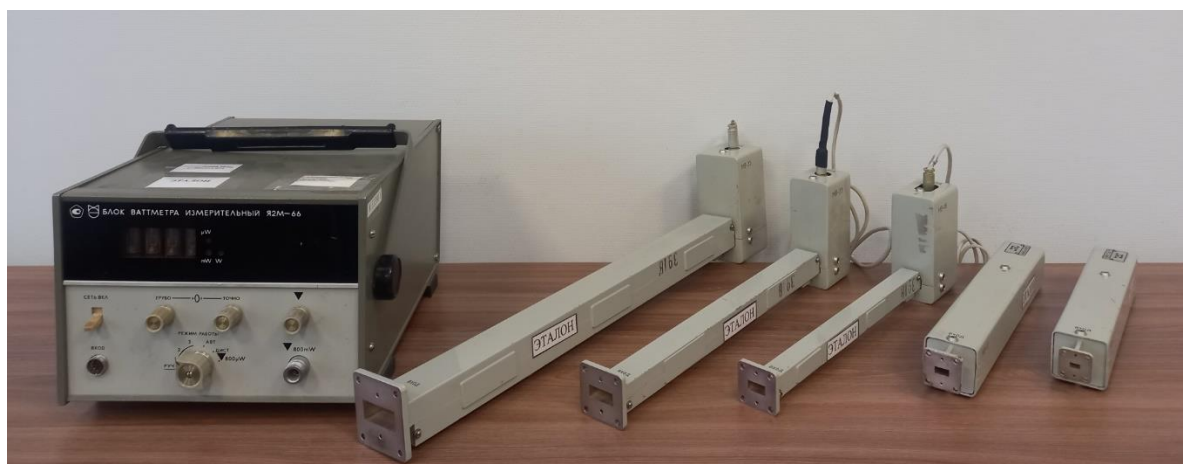
Рисунок 1 – Общий вид комплекта в составе возимых мер МВ-35, МВ-23, МВ-16, МВ-11, МВ-7 и блока ваттметра измерительного Я2М-66
