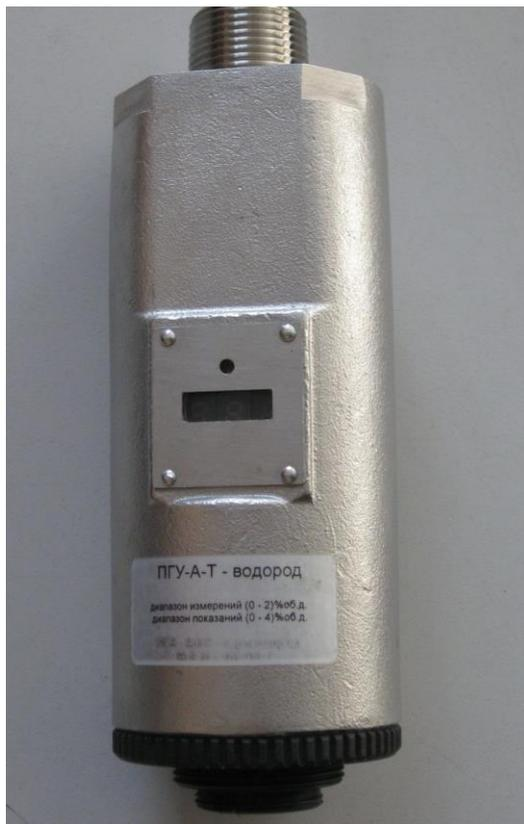
Рисунок 4 - Газоанализаторы СГАЭС-ТГМ14, ПИП – ПГУ-А-Т, общий вид
