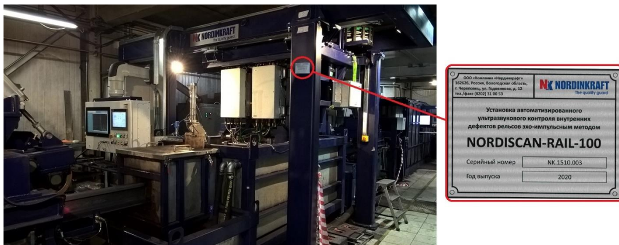
Рисунок 1 – Общий вид и место маркировки установки
