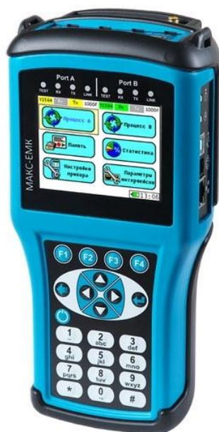
Рисунок 3 – Общий вид тестера-анализатора (модификация МАКС-ЕМК-Е)
