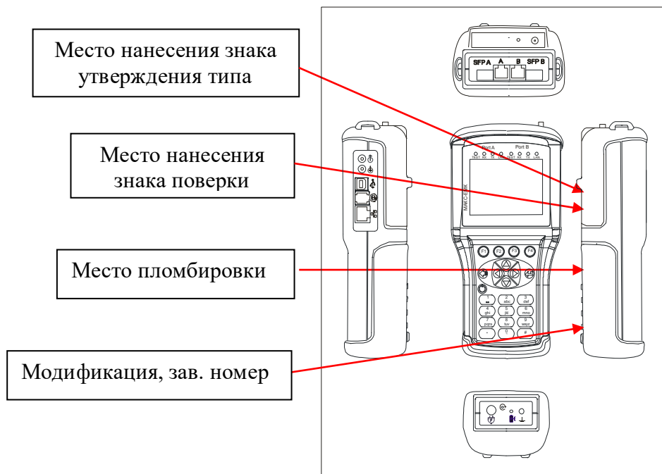
Рисунок 3 – Общий вид тестера-анализатора (модификация МАКС-ЕМК-Е)
