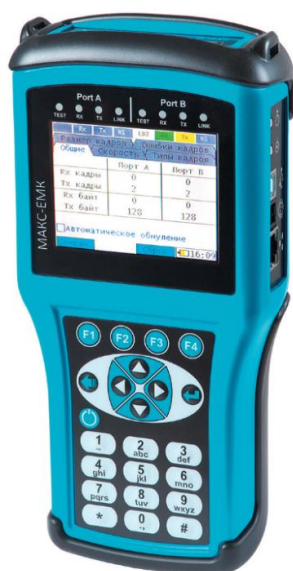
Рисунок 1 – Общий вид тестера-анализатора (модификация МАКС-ЕМК-В)
