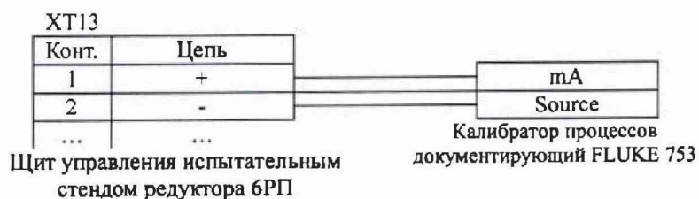
Рисунок А.3. Схема определения приведенной к ВП погрешности преобразования крутящего момента силы в значение силы постоянного тока первичной части ИК крутящего момента силы
