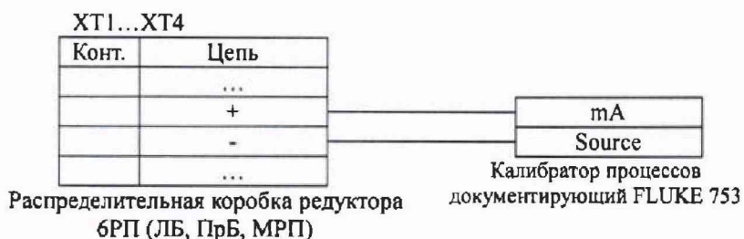
Рисунок А.1. Схема определения приведенной к ВП погрешности измерений вторичной части ИК давления и разности давлений
