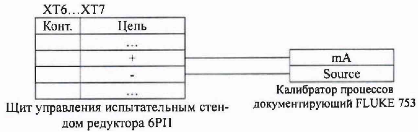
Рисунок А.6. Схема определения приведенной к ВП погрешности измерений вторичной части ИК силы переменного тока
