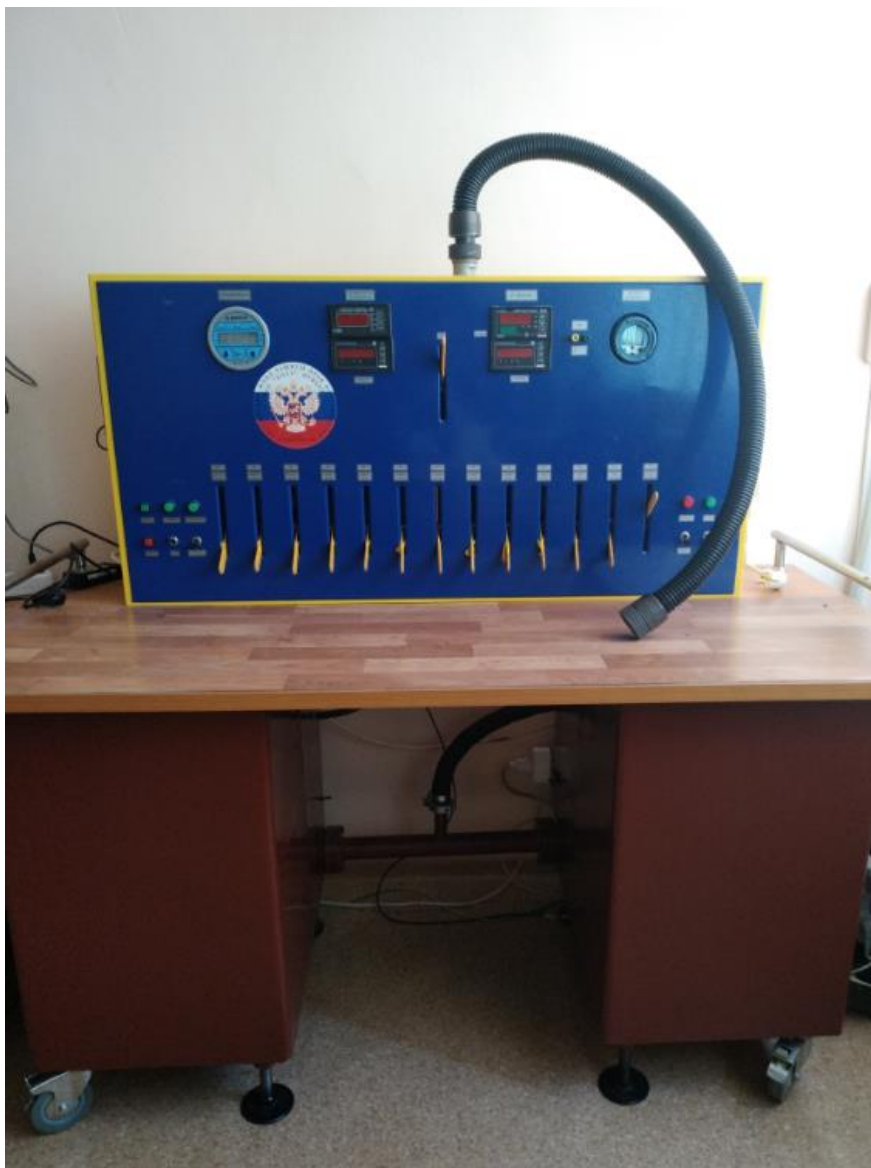
Рисунок 1 – Установка поверочная для счетчиков газа бытовых и ротаметров УПСГБ-16К
