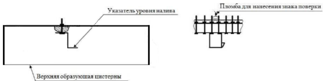
Рисунок 7 – Схема пломбировки от несанкционированного изменения положения указателя уровня налива, обозначение места нанесения знака поверки
