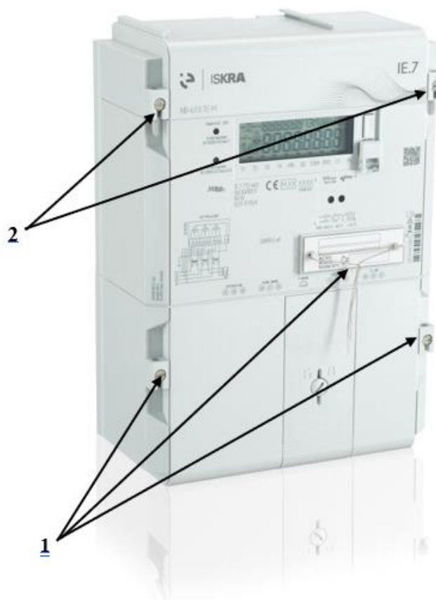
Рисунок 2 - Схема пломбировки от несанкционированного доступа (1) и обозначение места нанесения знака поверки (2) на счетчики
