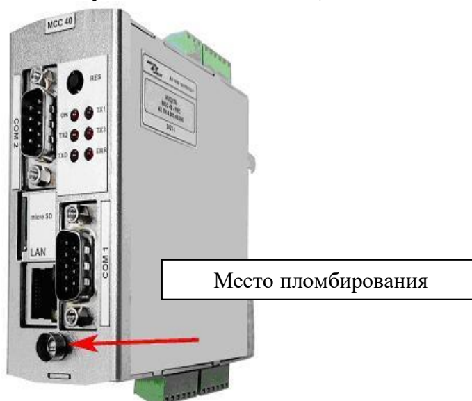
Рисунок 3 – Общий вид КТС.Х и схема пломбировки в исполнении КТС.24-02 (на базе модулей МСС 40 и МСС 08)
