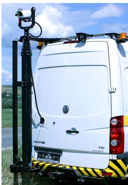
Рисунок 21 – Система учета интенсивности движения транспортных средств РДТ-808 канала учета интенсивности движения транспортных средств
