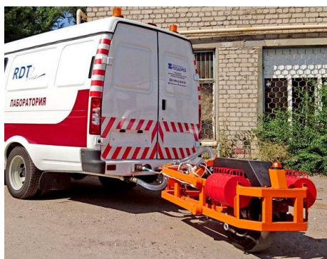
Рисунок 23 – Прибор контроля ровности и коэффициента сцепления ПКРС-2 РДТ канала измерений коэффициента сцепления покрытий
