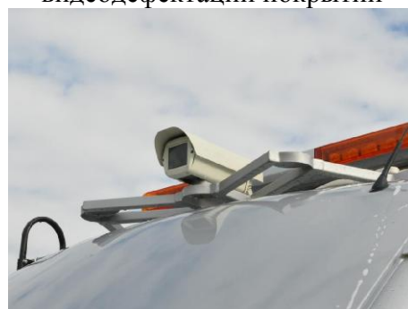
Рисунок 14 – Система видеосъемки РДТ-696.Н1 с 1-ой наружной камерой канала видеосъемки и измерений линейных размеров объектов по видеоизображению
