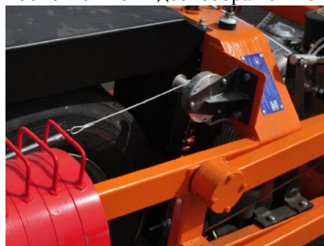
Рисунок 18 – Толкочмер РДТ-811 канала измерений амплитуды колебаний подвески прибора ПКРС
