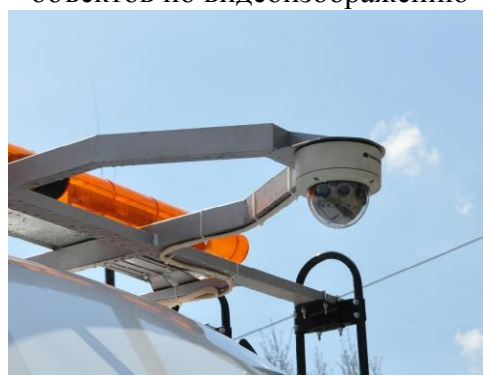
Рисунок 16 – Система видеосъемки РДТ-803 с 1-ой панорамной камерой канала видеосъемки и измерений линейных размеров объектов по видеоизображению
