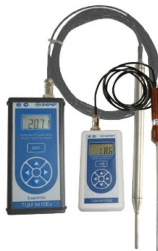
Рисунок 26 – Термометр цифровой малогабаритный ТЦМ-9410 канала измерений температуры воздуха, слоев и поверхностей
