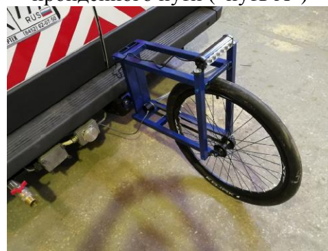
Рисунок 6 – Датчик «мерное колесо» РДТ-801 канала измерений длины пройденного пути («путь МК»)
