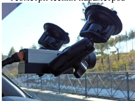
Рисунок 13 – Система видеосъемки РДТ-696.С1 с 1-ой салонной камерой канала видеосъемки и измерений линейных размеров объектов по видеоизображению
