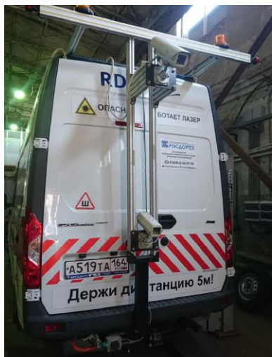
Рисунок 19 – Лазерно-оптический сканер РДТ-807 канала измерений поперечного профиля (колеи) покрытий
