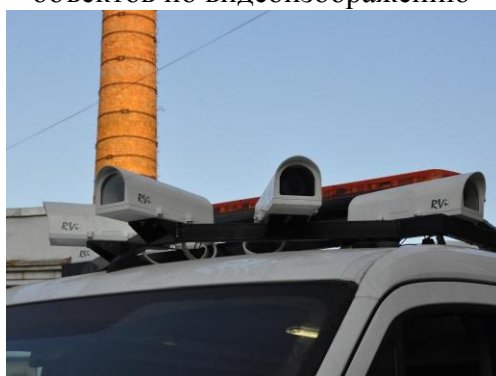
Рисунок 15 – Система видеосъемки РДТ-696.Н5 с 5-ю наружными камерами канала видеосъемки и измерений линейных размеров объектов по видеоизображению
