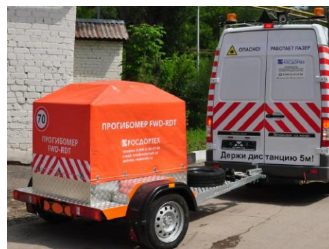
Рисунок 24 – Установка динамического нагружения "Прогибомер FWD-RDT" канала измерений упругого прогиба покрытий автомобильных дорог и аэродромов
