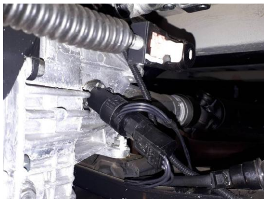
Рисунок 3 – Встроенный датчик пройденного пути РДТ-691.03 канала измерений длины пройденного пути («путь А»)
