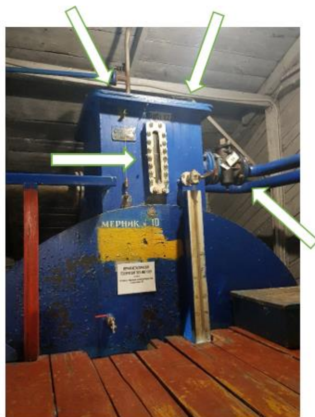
Рисунок 2 – Схема пломбировки мерника ММГ-1000У, зав.№ 10, от несанкционированного доступа, обозначение места нанесения знака поверки
