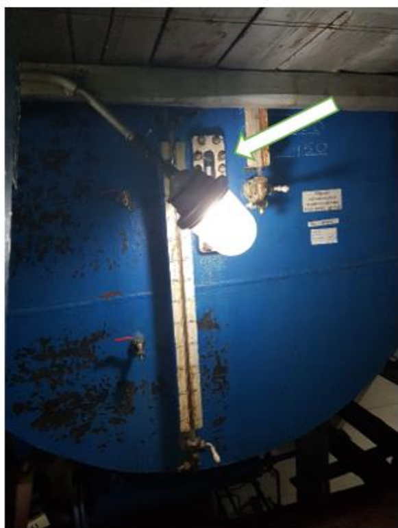
Рисунок 2 – Схема пломбировки мерника ММГ-1000У, зав.№ 10, от несанкционированного доступа, обозначение места нанесения знака поверки
