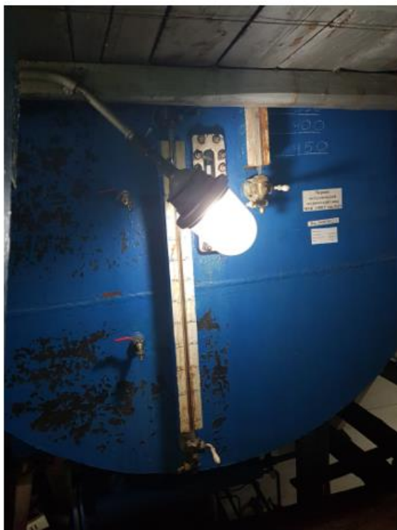
Рисунок 1 - Общий вид мерника ММГ-1000У, зав.№ 10
