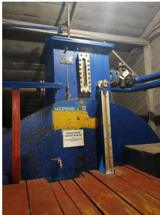
Рисунок 1 - Общий вид мерника ММГ-1000У, зав.№ 10
