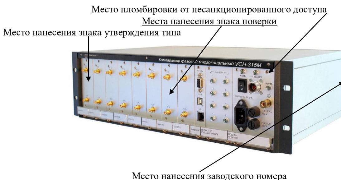
Рисунок 2 – Обозначение места нанесения заводского номера и схема пломбировки от несанкционированного доступа (исполнение ЯКУР.411146.042)
