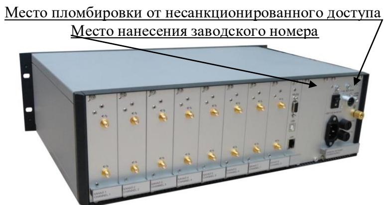
Рисунок 2 – Обозначение места нанесения заводского номера и схема пломбировки от несанкционированного доступа (исполнение ЯКУР.411146.042)
