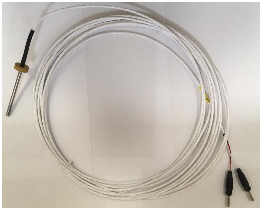
Рисунок 1 - Общий вид термопреобразователей сопротивления платиновых 502-0400
